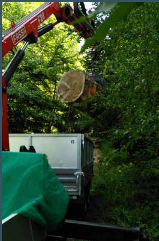
Dans certains cas, il faut même faire appel à des grues pour transporter et mettre en place les lourdes imitations de cavités.
