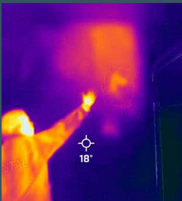
Détection d'un couvain d'abeilles mellifères dans un mur à l'aide d'une caméra thermique. Photo : Francis Cordillot & Axelle Lesebos.
